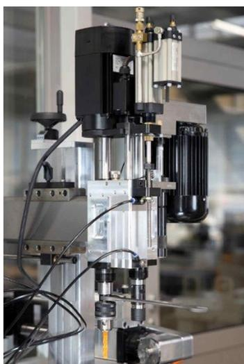
gfnd2101\_b6: Bohreinheit B050 mit hydraulischer Vorschubregulierung „Hydro-Check“ (oben) und Zahnkranzbohrfutter Fotos: Grotefeld GmbH
