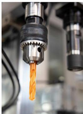
gfnd2101\_b1: Zahnkranzfutter auf Bohreinheit B50
