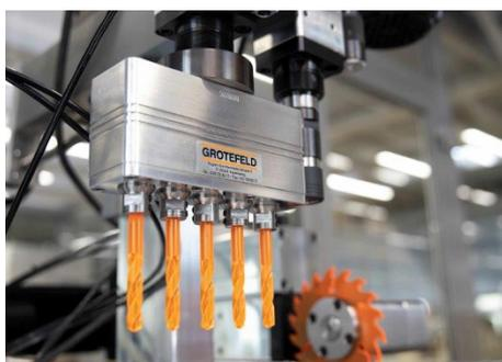
gfnd2101\_b5: Mehrspindelgetriebe auf Bohreinheit B050
