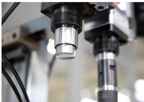
gfnd2101\_b4: Bohreinheit B050 mit dem aufgesetztes Antriebsstück für die Mehrspindelgetriebe UNI2 oder DPL
