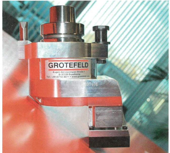
▼ Ein Federhub der Ansaugplatte von maximal 3 mm und eine Andruckkraft von bis zu 70 N gewährleisten eine präzise, dauerhafte Etikettenplatzierung
