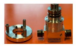
gfnd2203\_b2: Vier Schrauben herausgedreht und die Antriebsdeckel getauscht – so einfach geht das jetzt!
