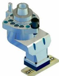
gfnd1808\_b2: Ein Federhub der Ansaugplatte von max. 3 mm und eine Andruckkraft von bis zu 70 N gewährleisten eine präzise, dauerhafte Etiketten-Platzierung durch das Aggregat FN7-1.0 auch auf Werkstücken mit Oberflächentoleranzen.
