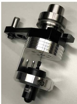
gfnd1804\_b2: Die Stifte für Beschriftungsarbeiten werden im Aggregat GT22 gefedert eingebunden, um Toleranzen in der Werkstückoberfläche auszugleichen und um diese nicht zu beschädigen.
