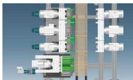
gfnd1803\_b2: Eine moderne Leimbinder-Bearbeitung erfolgt mit Bohr-Spezialmaschinen. Bohrer bzw. Werkzeuge (grün) werden von Grotefeld-Aggregaten (weiß) aufgenommen und angesteuert.
