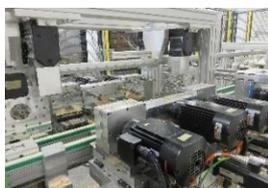
gfnd1803\_b3: Binder-bohren im Durchlauf: Beidseitig der Straße sitzen die kräftigen, hochpräzisen Aggregate von Grotefeld. Gut erkennbar die verschiedenen eingesetzten Werkzeuge.
