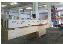
gfnd1803\_b5: Das Ergebnis vor Auslieferung an die Baustelle: Binder für die Dachkonstruktion mit definierten Lochnestern (li.) und Einzelbohrungen, teilweise mit Lager- und Nagelplatten belegt.
