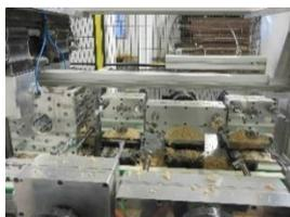
gfnd1803\_b4: Detailaufnahme mit unterschiedlichen Bohrwerkzeugen im Fokus – links im Bild eine Bohrbrille, die zusätzliche Laufruhe selbst bei Bohrerlängen über 50 cm gewährleistet.
