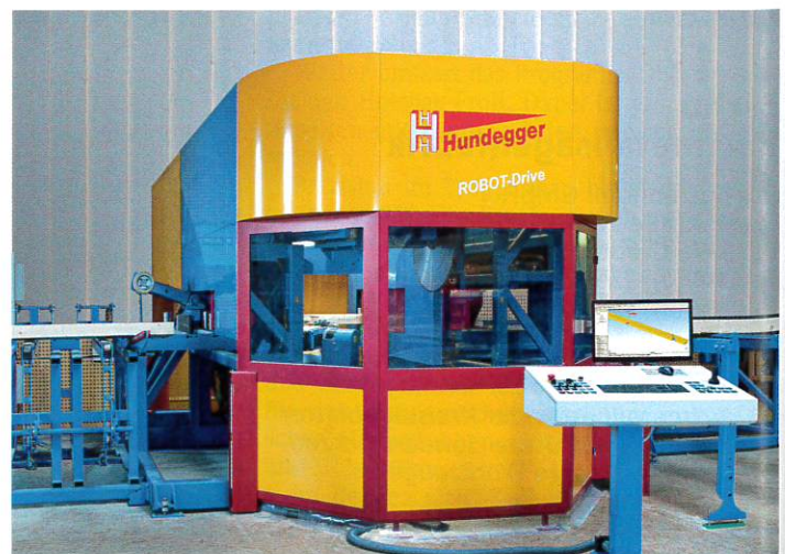
Abbundmaschine „Robot-Drive“ (Hundegger)
